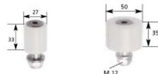
Führungsrolle mit Kunststoffrolle. Freilauf der Gleitlager über Buchse. Achsstummel mit Achsschraube und Mutter.
