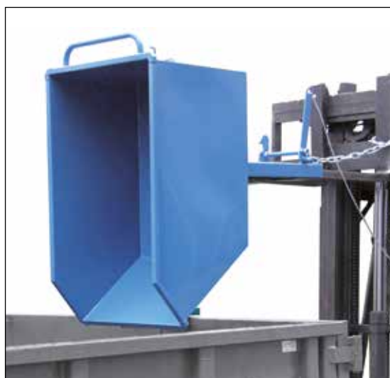
Kippbehälter als Abfallbehälter mit Gabelstapler
