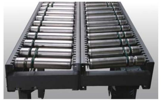
Zweigeteilte Schrägrollenbahn zum mittigen Ausrichten des Fördergutes.
