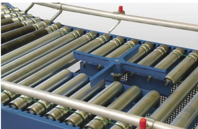
Hub- Drehkreuz eingebaut in eine Rollenbahn zum Ändern der Laufrichtung des Fördergutes.
