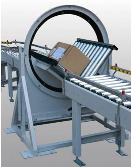
Elektromotorische Drehvorrichtung mit zwei Stück angetriebenen Rollenbahnen zum seitlichen Drehen des Fördergutes um 90°.
