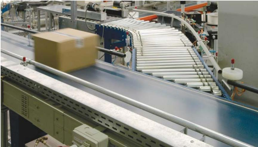
30° Einschleusstation mit Umlenkrolle auf einen Gurtförderer, um schnellere Taktzeiten zu erreichen. Die Laufrichtung des Fördergutes bleibt unverändert.
