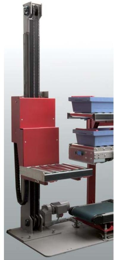
Pneumatisch heb- senkbarer Zahnriemenförderer, eingebaut in zwei Rollenbahnen, für die rechtwinklige Übergabe.
