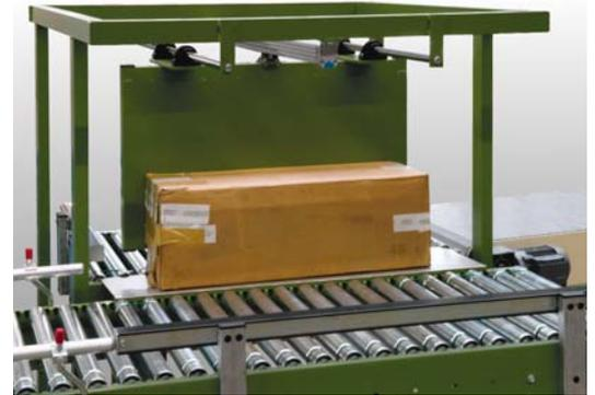
Pneumatische Abschiebeeinheit als Portal über der Rollenbahn angeordnet.
